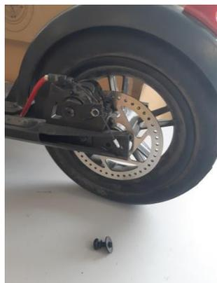
Mettre une pointe de Frein Filet sur les vis Allen (Taille 5) & Revisser les de part et d'autre de la fourche pour maintenir la roue arrière.
