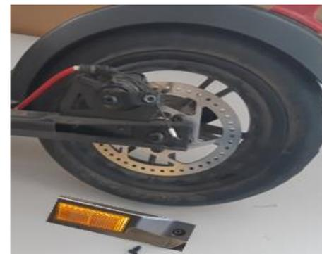
Repositionner les capots de protection de la fourche et revisser les vis allen (taille 2,5)
