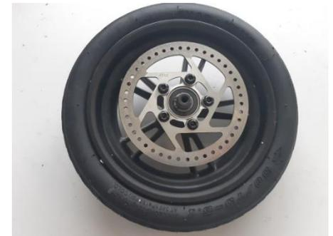
Si vous disposez d'une clé dynamométrique, les vis sont à serrer avec un couple de serrage de 8 à 10 Nm
