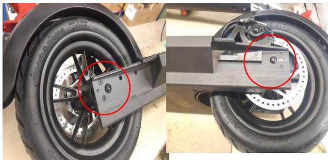
Retirer les vis allen (taille 5) de part et d'autre de la fourche qui maintiennent la roue arrière.
