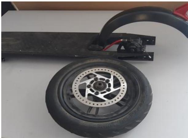
Repositionner la roue en prenant soin de glisser le disque dans l'étrier de frein.
