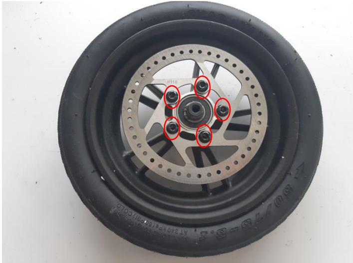
Puis retirer le disque de frein du moyeu de la roue.
